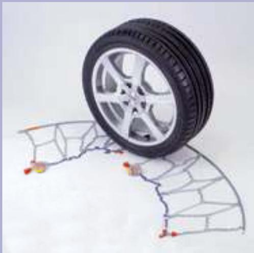
**IT** Lasciate cadere la catena per terra e spostate lentamente la vettura avendo cura di non passare sopra il dispositivo di tensionamento. Prima di riporre la catena nella confezione eseguite l'operazione a pag.6.
