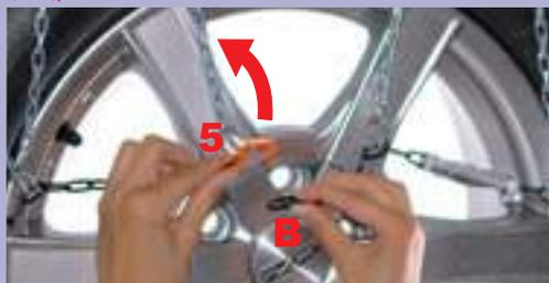
**IT** Tirate la catena verso di voi e poi in basso fino ad avere le estremità del cavo (1 e 2) accessibili. Sganciate i terminali (4-5) o (5-B) nel caso aveste il modello di catena UNIQA.
