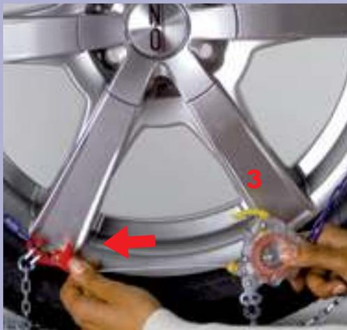
**IT** Impugnate il dispositivo di tensionamento (3) ed estraete completamente il cavo, che sarà così pronto per lo sganciamento.
