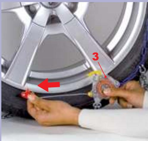
**IT** Impugnate il dispositivo di tensionamento (3) ed estraete completamente il cavo, che sarà così pronto per l'agganciamento.
