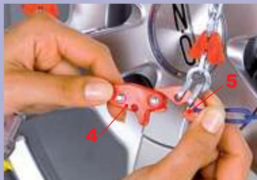
**IT** Impugnate il dispositivo di tensionamento (3) ed estraete completamente il cavo, che sarà così pronto per l'aggancio.
